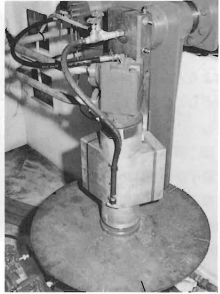
写真2 アークソー切断装置(右)と切断状況(左)
